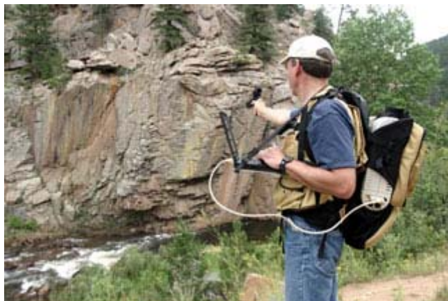
Rys. 5. Spektrometr: ASD pracujący w zakresie VNIR [ http://www.asdi.com/products-spectroradiometers.asp ]
