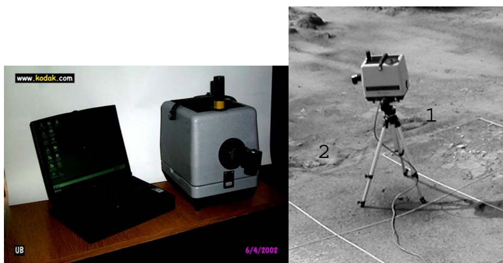
Rys. 6. Spektrometr : Micro Fourier Transform Interferometer firmy Design&Prototypes pracujący w zakresie TIR
