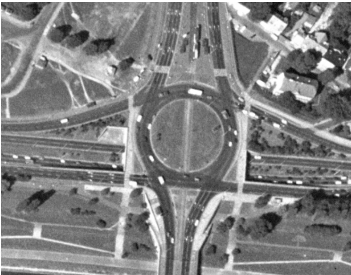
Rys.5. Ortofotomapa pozwala nie tylko aktualizować dane przestrzenne ale posiada także duży potencjał w zakresie danych opisowych, pozwala określić liczbę pasów ruchu, rodzaj nawierzchni, wnioskować o natężeniu ruchu (fragment ortofotomapy wykonanej ze zdjęć w skali 1:26 000)
