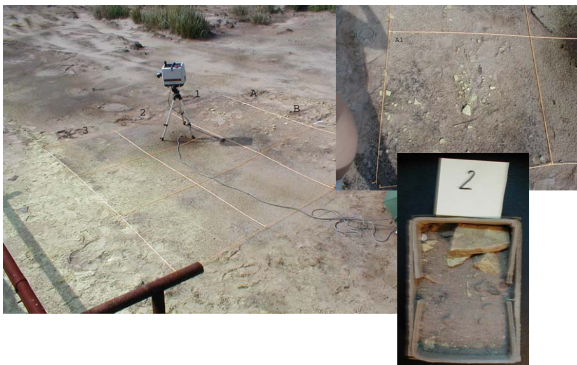
Rys. 12. Elementarne pole testowe (9 kwadratów – z lewej), powiększenie pojedynczego kwadratu (z prawej u góry), próba laboratoryjna (z prawej u dołu).
