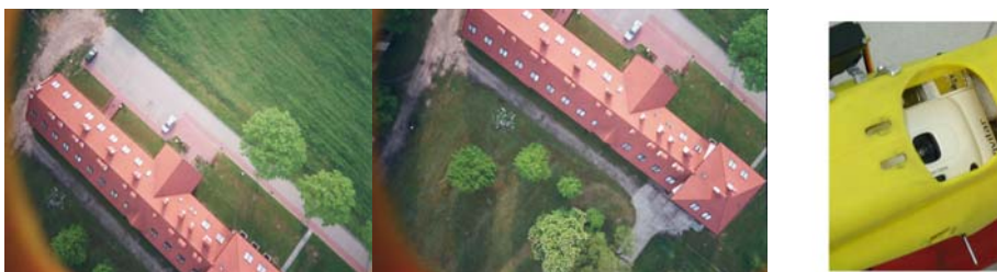
Rys. 1. Przykładowa, jedna z kilkudziesięciu par zdjęć niskopułapowych, realizowanych na terenie WIŚiG Akademii Rolniczej przy ul. Balickiej w Krakowie z zastosowaniem hybrydowej konstrukcji lotniczej (motolotni-samolotu, rozpiętość 1.8 m), wyposażonej w aparat fotograficzny Vivitar, f=25\text{mm} (z prawej).
