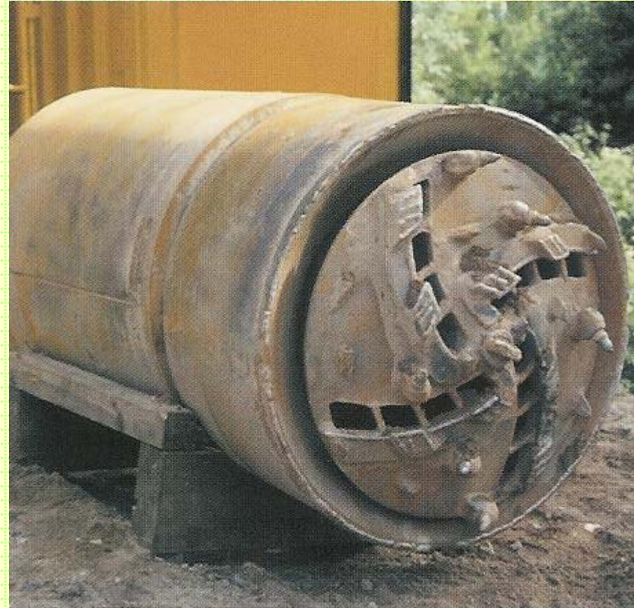
przegubowa konstrukcja głowicy wiertniczej
