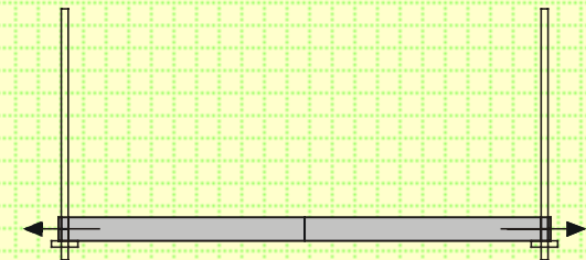
Zniszczenie przez rozciąganie
