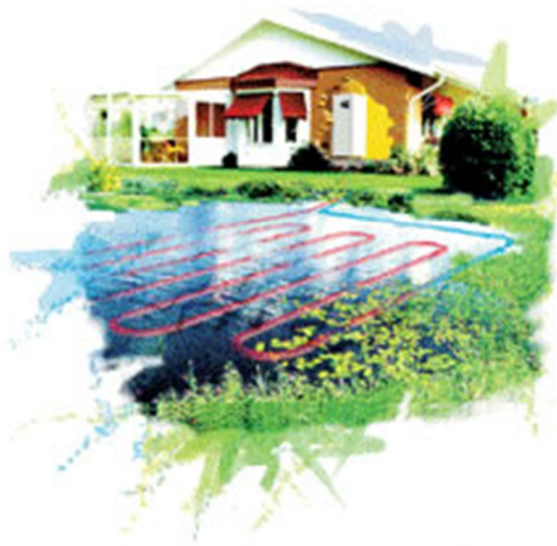
Pompa ciepła, pobierająca ciepło z wody przez kolektor poziomy
