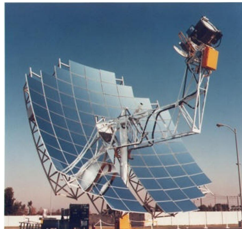
Kolektor skupiający paraboliczny z układem nadążnym
