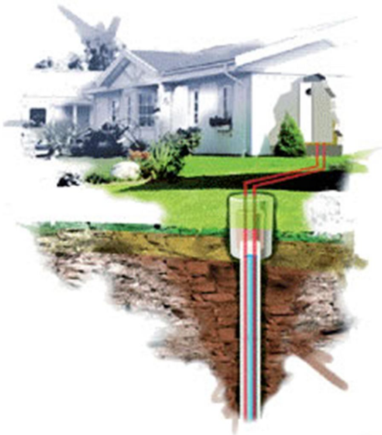
Pompa ciepła, pobierająca ciepło z gruntu przez kolektor pionowy
