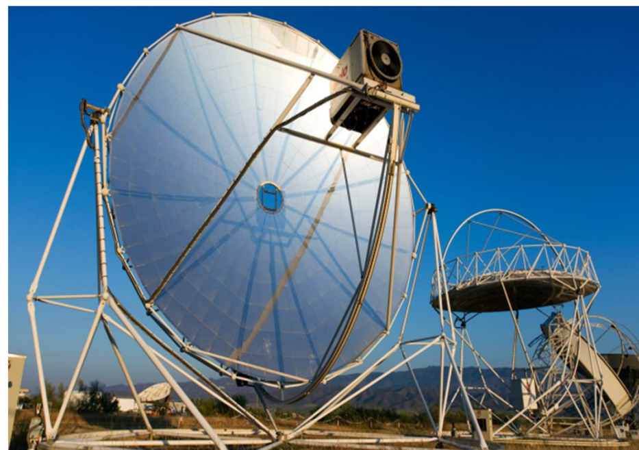
Kolektor paraboliczny dyskowy z silnikiem Stirlinga
