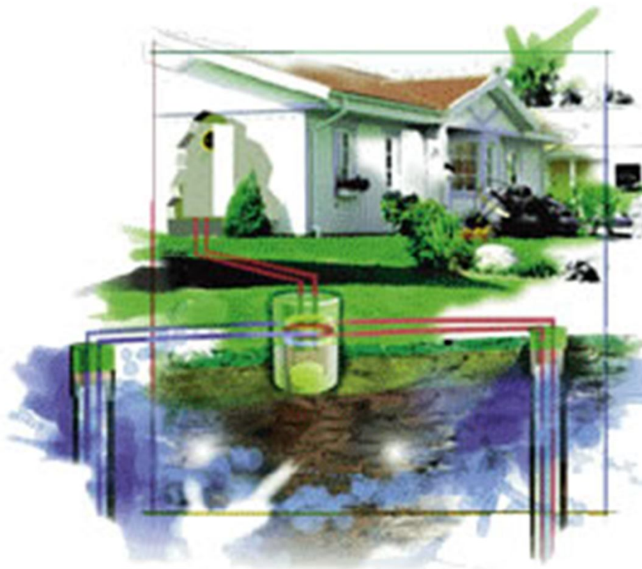
Pompa ciepła, pobierająca ciepło z wody przez układ dwóch studni głębinowych
