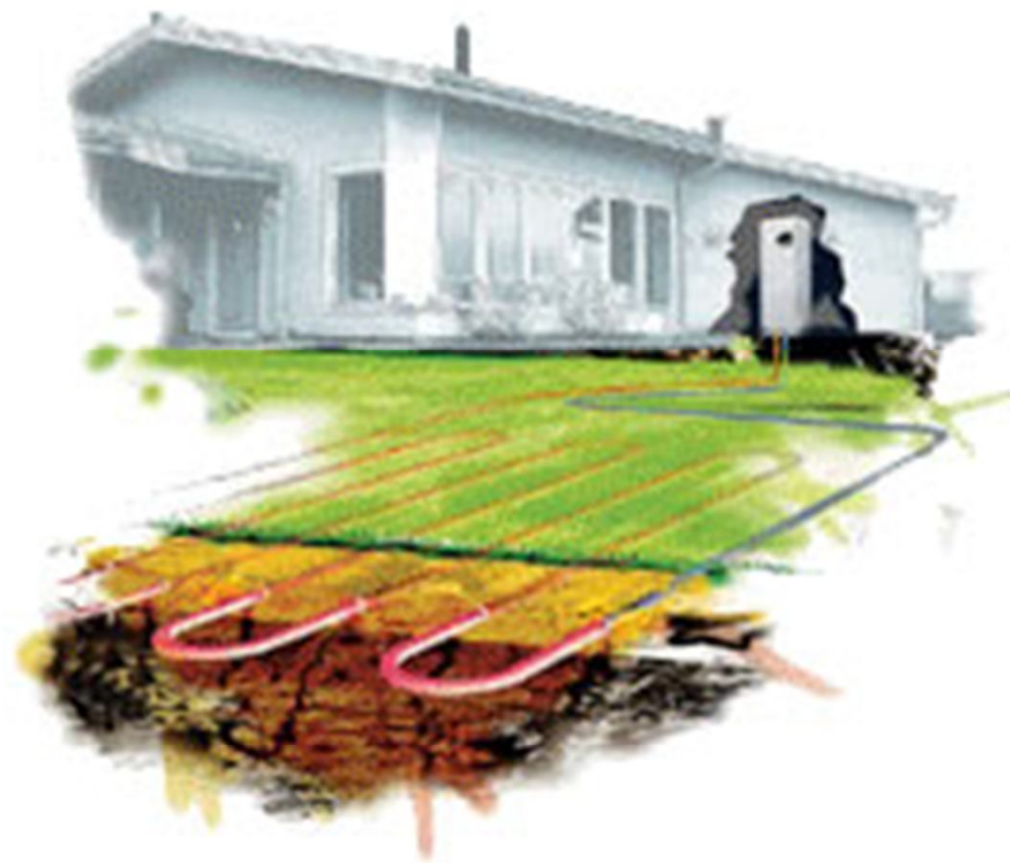
Pompa ciepła, pobierająca ciepło z gruntu przez kolektor poziomy
