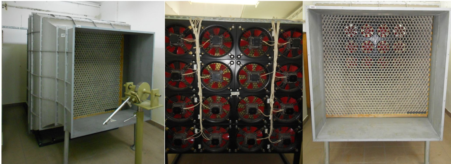
Stanowisko do badania małych elektrowni wiatrowych
