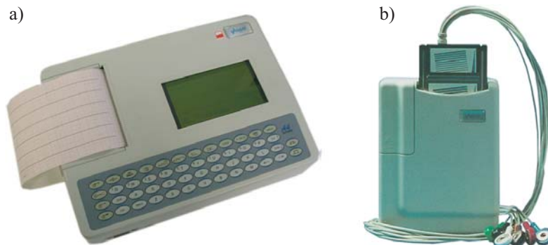
Ryc. 1. Rodzaje elektrokardiogramów: a) elektrokardiogram przyłóżkowy, b) długoczasowy rejestrator EKG, źródło: Aspel SA
