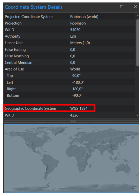
Ryc. 42. Parametry projekcji kartograficznej Robinson (world); ramką zaznaczono GCS wykorzystywany przez odwzorowanie
