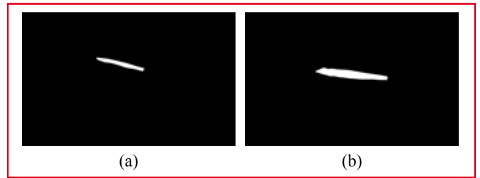
Rys. 6. Widok kity płomienia po operacji progowania
