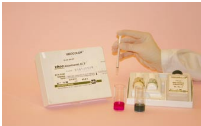
Fot. 2. Prosty test miareczkowy do oznaczania zasadowości z barwnym indykatorem.
