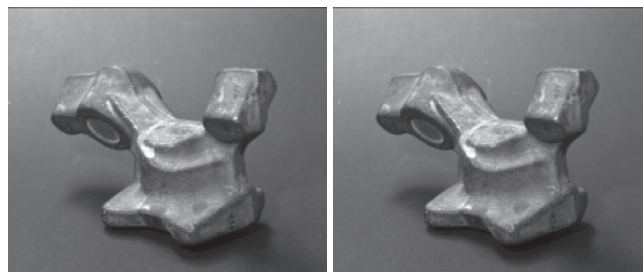
Rys. 2. Przykład pary obrazów stereoskopowych (część Renault, INRIA C). Aby zaobserwować efekt głębi, należy ustawić pionową kartkę papieru i obserwować tak, aby oko lewe patrzyło wyłącznie na obraz lewy, a prawe na prawy
