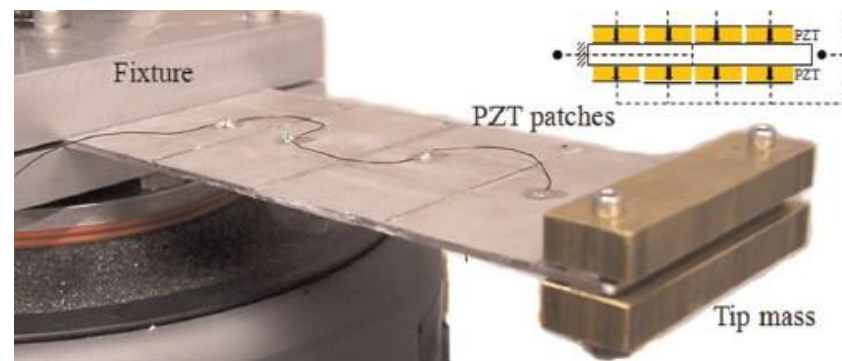
Rys.4. Przykład zastosowania ceramiki PZT: układ do pozyskiwania energii z drgań
