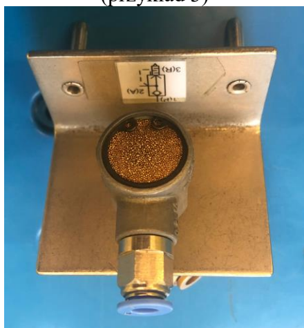
Rys. 11. Zawór szybkiego spustu (przykład 1)
