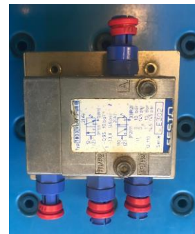
Rys. 4. Zawór 3/2 sterowany ciśnieniem (przykład 1)
