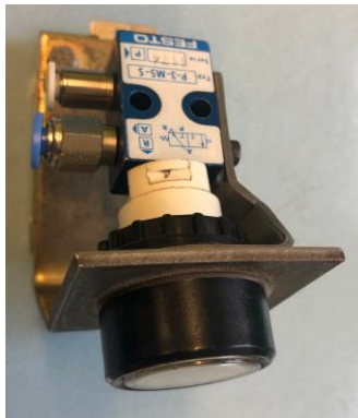
Rys. 3. Zawór 3/2 sterowany przyciskiem (przykład 2)
