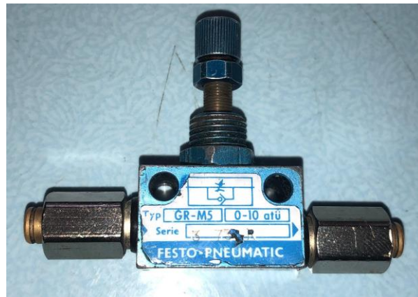
Rys. 10. Zawór dławiąco-zwrotny (przykład 4)
