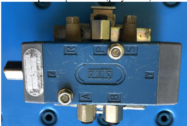
Rys. 5. Zawór rozdzielający 5/2 sterowany za pomocą ciśnienia (przykład 3)
