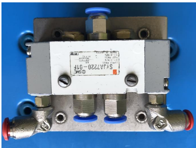
Rys. 7. Zawór rozdzielający 5/2 sterowany za pomocą ciśnienia (przykład 5)
