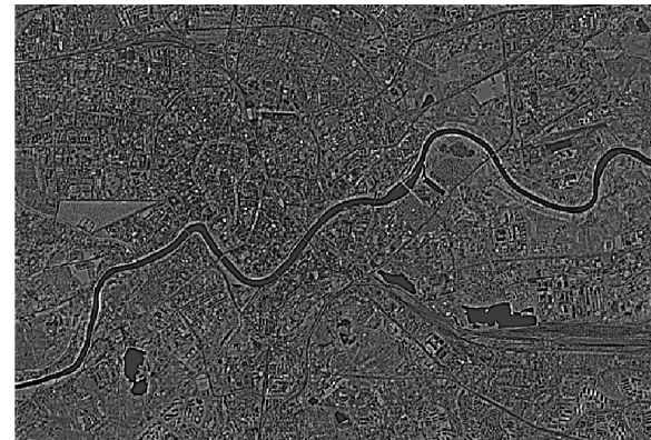
Landsat7 – obraz panchromatyczny i efekt filtracji filtrem wzmacniającym krawędzie
