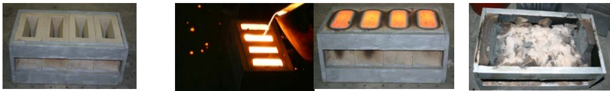
Rys. 1. Proces otrzymywania odlewu: a) widok form odlewniczych wykonanych z użyciem spoiwa polimerowego przed zalaniem, b) zalewanie formy ciekłym metalem, c) widok form odlewniczych po zalaniu ciekłym metalem, d) widok masy zużytej po procesie zalewania ciekłym metalem (fot. B. Grabowska)
