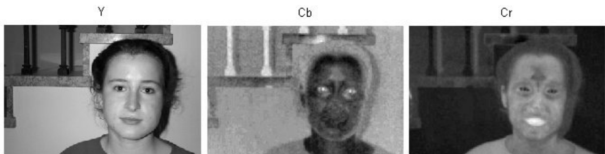
Rys. 2.5. Składowe kolorowego obrazu w przestrzeni YCbCr
