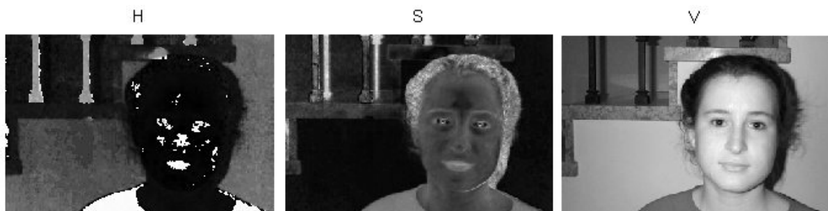
Rys. 2.4. Składowe kolorowego obrazu w przestrzeni HSV
