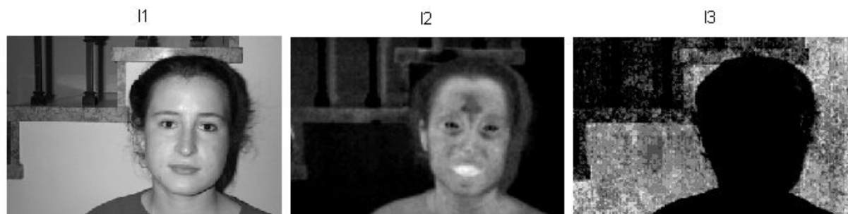
Rys. 2.6. Składowe kolorowego obrazu w przestrzeni I1I2I3
