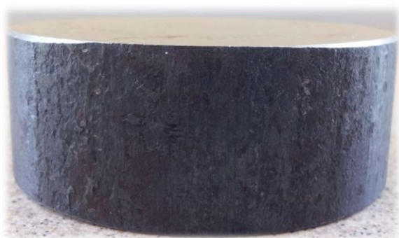
Rys. 9. Próbka kalibracyjna stalowa (wysokość próbki: 30 mm)
