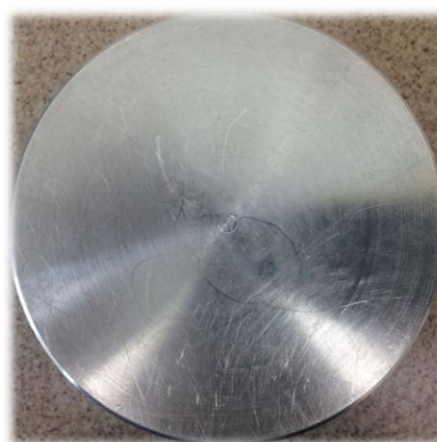
Rys. 10. Próbka kalibracyjna duraluminiowa (wysokość próbki: 50 mm)
