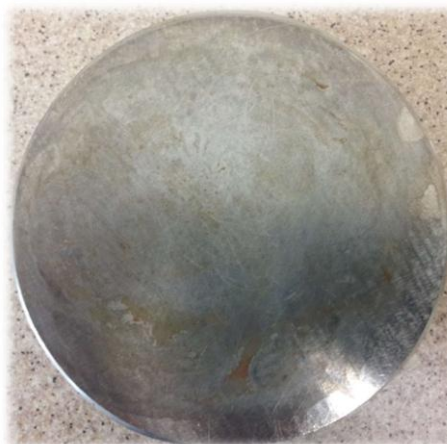
Rys. 9. Próbka kalibracyjna stalowa (wysokość próbki: 30 mm)
