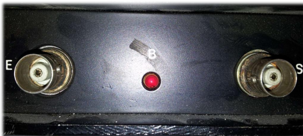
Rys. 8. Wyjście do instalowania przewodu głowicy piezokwarcowej (S). Uwagę zwraca dioda zasilania (B)
