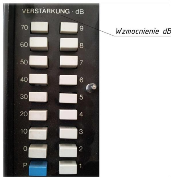
Rys. 12. Panel sterowania, widok strony lewej – przyciski wzmacnienia fali
