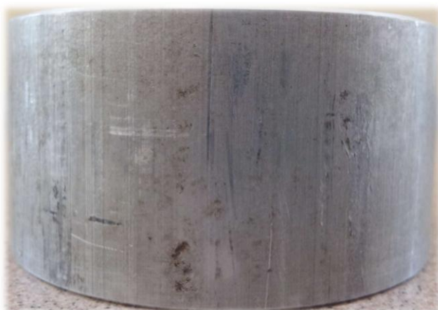
Rys. 10. Próbka kalibracyjna duraluminiowa (wysokość próbki: 50 mm)
