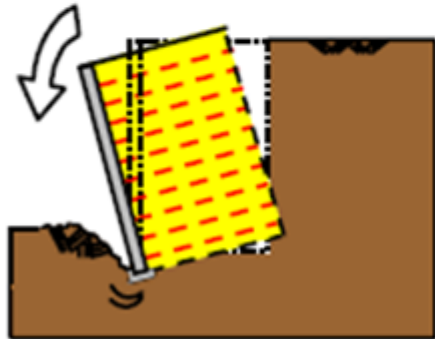
Utrata nośności podłoża
