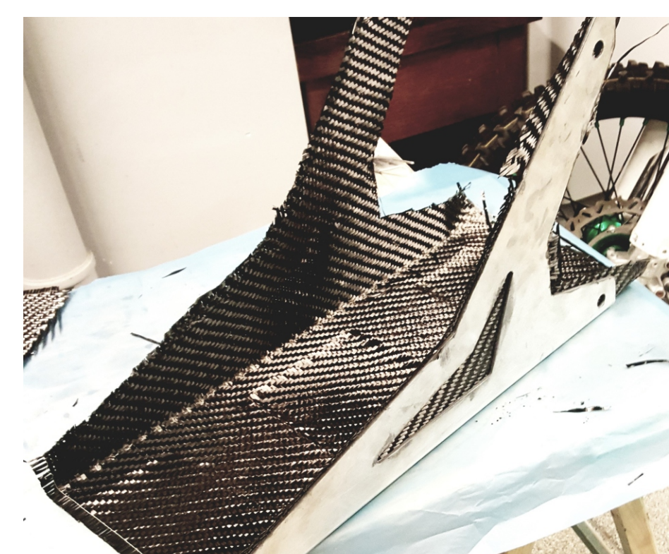
Rys.6. Rdzeń subramy z nałożoną pierwszą warstwą tkaniny węglowej
