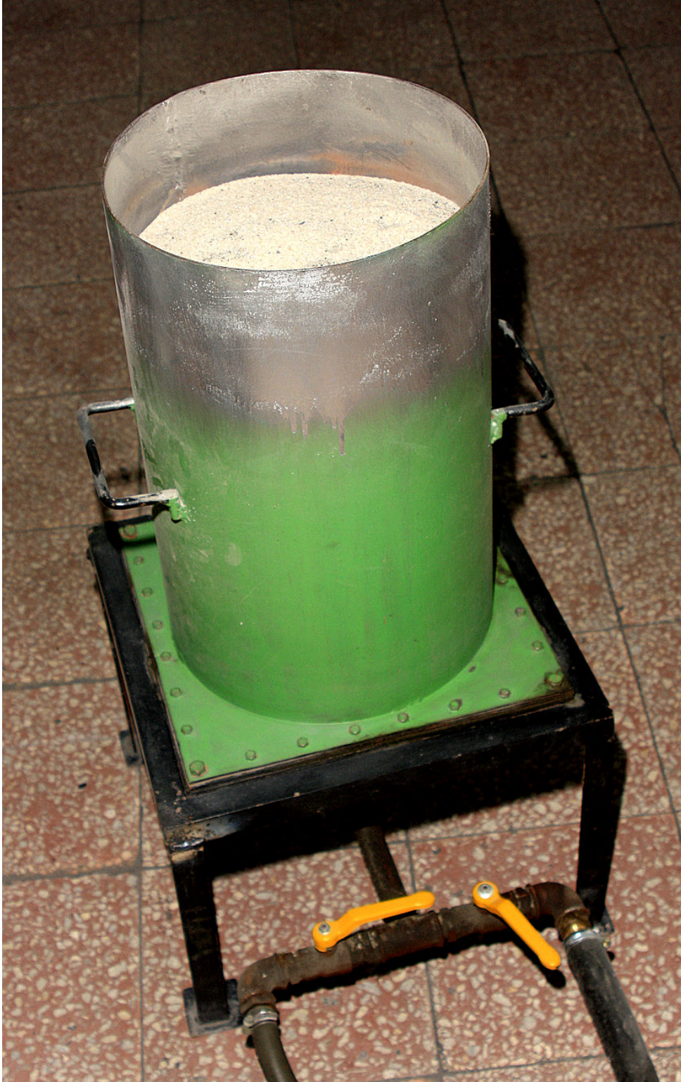
Rys.5. Urządzenie do formowania modeli styropianowych w złożu fluidalnym piasku
