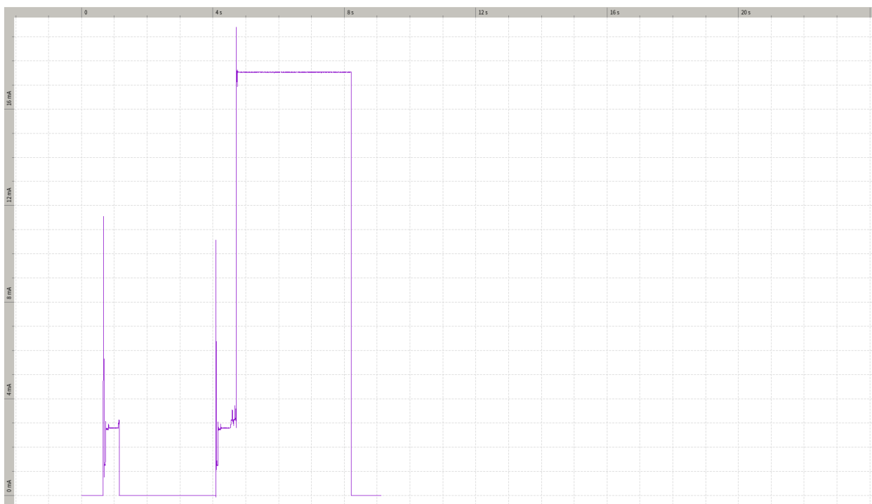
Rys. 4.10. Błędne funkcjonowanie urządzenia przy napięciu zasilania 1.8V
