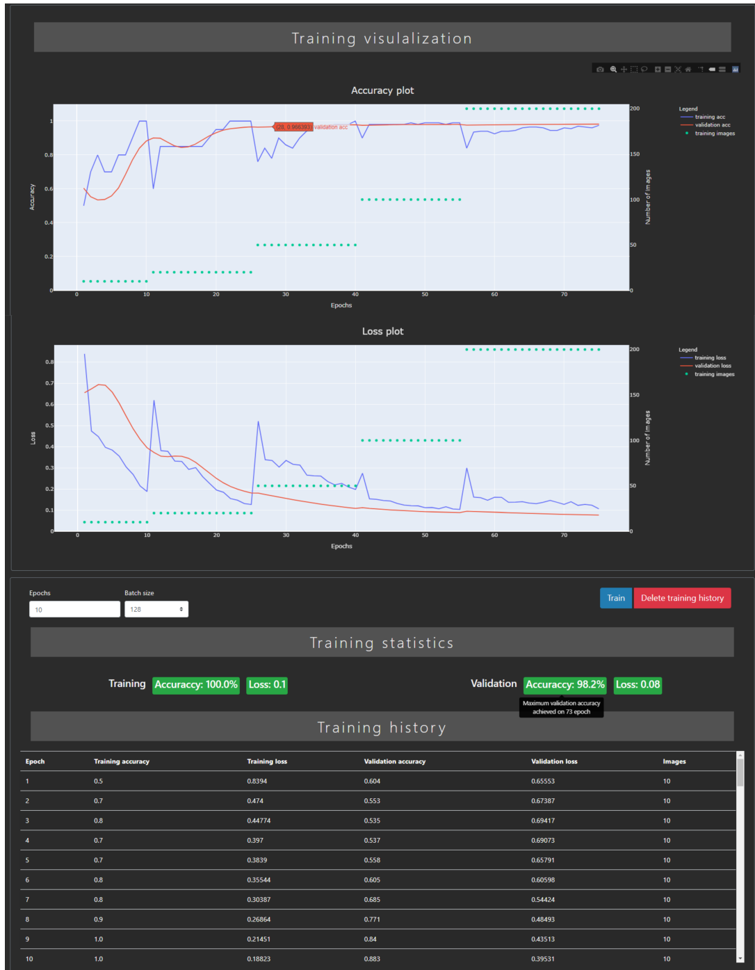
Rysunek 2.13: Wizualizacja procesu uczenia za pomocą wykresu skuteczności (wykres górny) i wartości funkcji kosztu (wykres dolny) modelu oraz tabeli zawierającej dane z wszystkich epok
