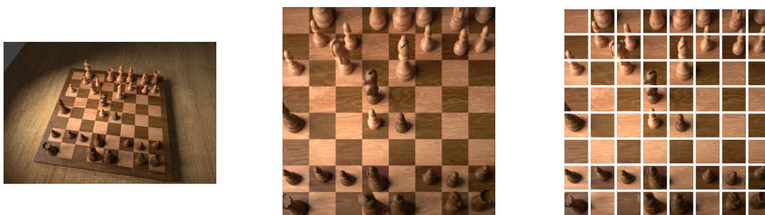
Rys. 8. Od lewej: Oryginalny obraz, wejściowy obraz dla modeli YOLO oraz CNN dla całej szachownicy, wejściowe obrazy dla modelu CNN dla pojedynczego pola.
