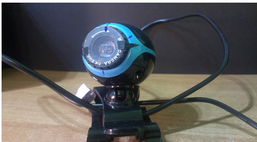
Rys. 8 Kamera internetowa z zamontowaną siatką dyfrakcyjną
