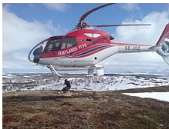
Rys. 1.6 Efekt rolling shutter : na obrazie widoczne są zniekształcenia śmigła helikoptera 6
