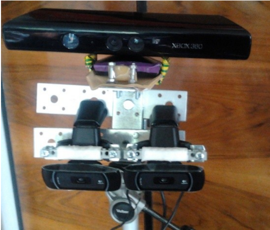
Rys. 2.5 Statyw pomiarowy z kamerami Logitech B910 i urządzeniem Kinect
