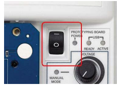
Rys. 21. Wyłącznik główny platformy ELVIS II Rys. 22 Włączanie zasilania płyty montażowej
