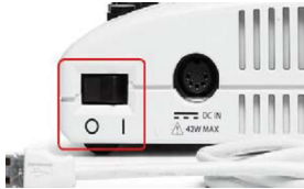
Rys. 21. Wyłącznik główny platformy ELVIS II Rys. 22 Włączanie zasilania płyty montażowej
