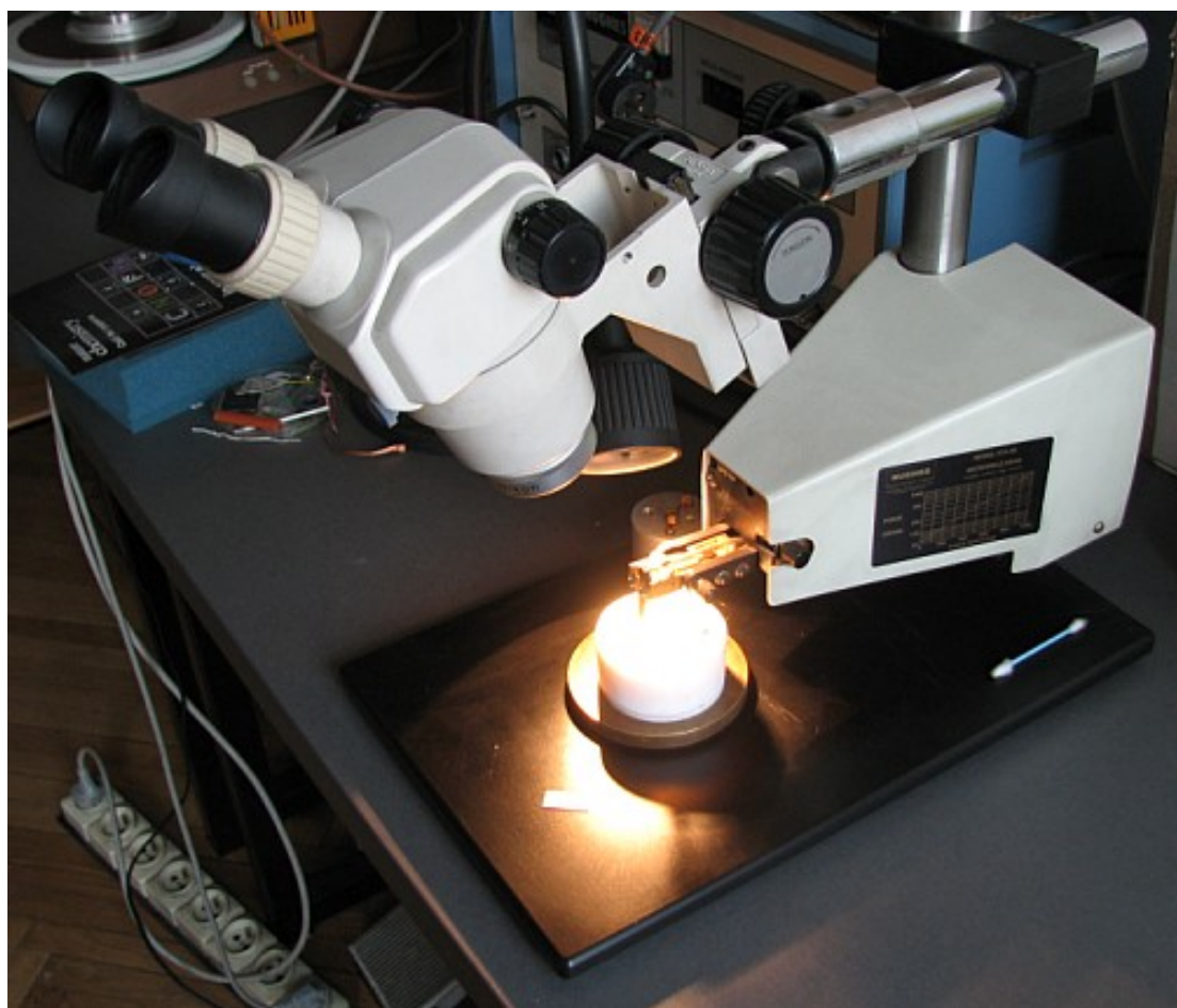
Rys. 5. Ogólny widok mikrogrzewarki. Widoczny mikroskop, stolik teflonowy, głowica z elektrodami
