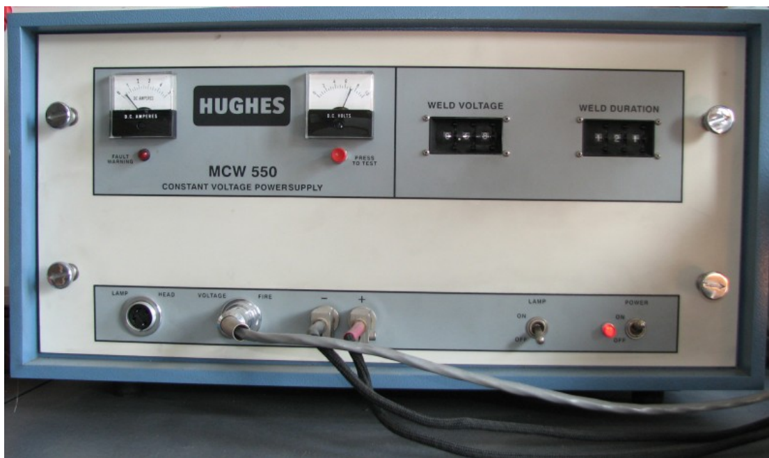
Rys. 6. Panel czołowy jednostki głównej mikrozgrzewarki z zasilaczem. Widoczne nastawy czasu i napięcia zgrzewania, wskaźniki informują o wartościach napięcia i prądu
