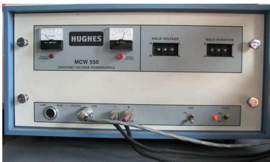
Rys. 2. Panel czołowy jednostki głównej mikrogrzewarki z zasilaczem. Widoczne nastawy czasu i napięcia zgrzewania, wskaźniki informują o wartościach napięcia i prądu
