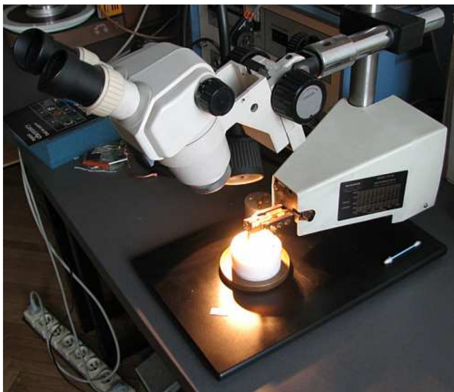
Rys. 1. Ogólny widok mikrogrzewarki. Widoczny mikroskop, stolik teflonowy, głowica z elektrodami
