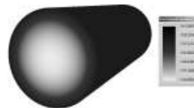
Pole temperaturowe we wsadzie o przekroju okrągłym.
