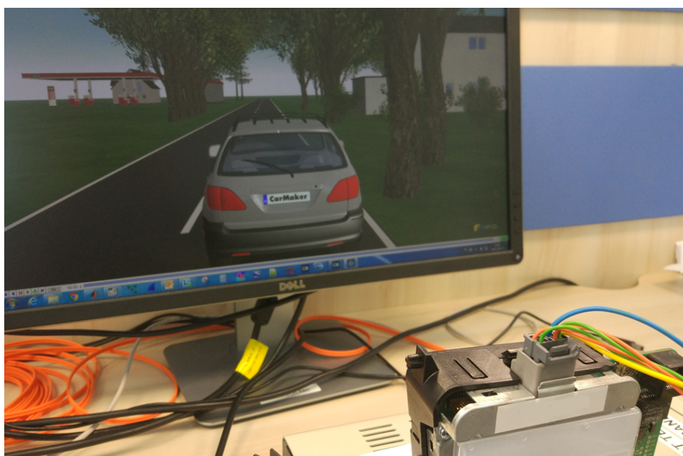
Rysunek 1.2. Kamera ADAS ustawiona na przeciwko monitora podczas symulacji Hardware-in-the-Loop , źródło: opracowanie własne
