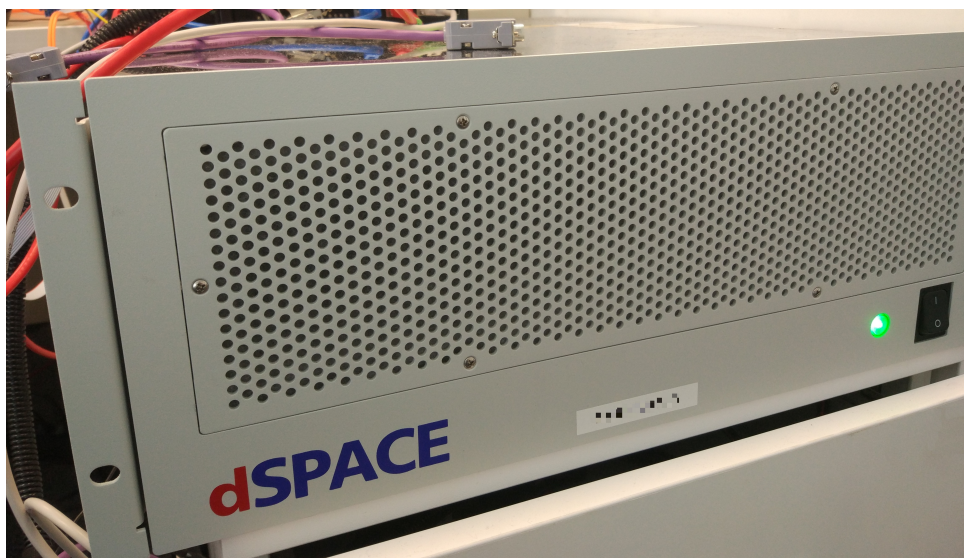
Rysunek 2.3. Jednostka dSPACE z zainstalowanym procesorem DS1006 i kartami rozszerzeń, źródło: opracowanie własne
