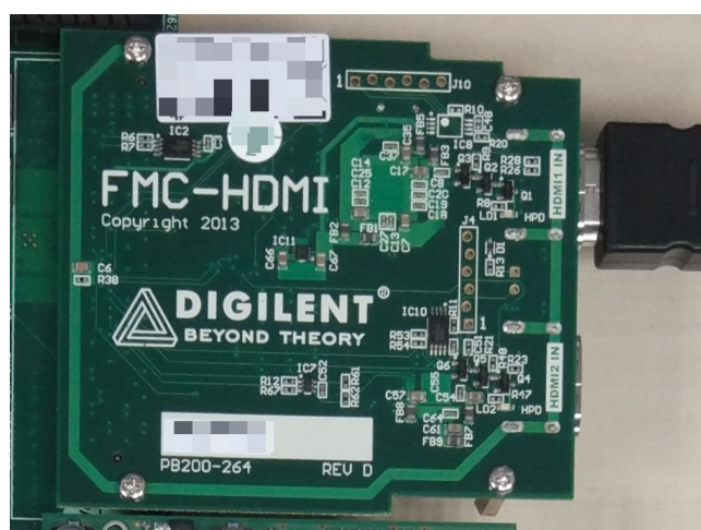
Rysunek 2.5. Karta z interfejsem FMC, rozszerzająca interfejsy płyt z FPGA o wejście HDMI, źródło: opracowanie własne
