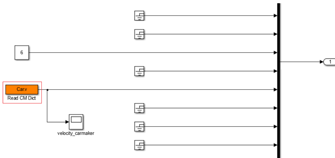
Rysunek 2.12. Fragment modelu stworzonego w aplikacji Simulink wraz z blokiem Read CM Dict , umożliwiającą komunikację z programem CarMaker , źródło: opracowanie własne
