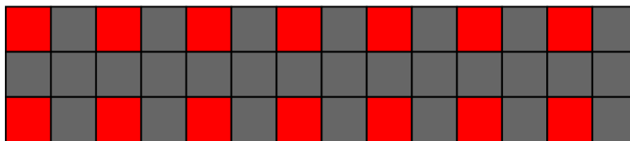
Rysunek 2.2. Filtr RCCC stosowany w przemyśle samochodowym, każdy kwadrat oznacza jedn piksel, źródło: opracowanie własne na podstawie [9]
