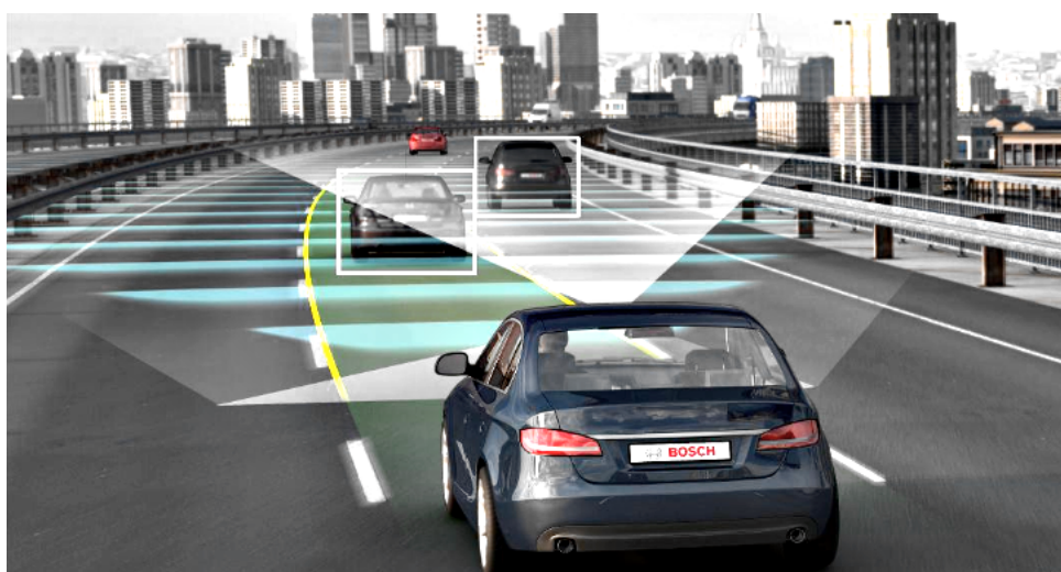
Rysunek 1.1. Rozpoznawanie samochodów i pozostałych elementów ruchu drogowego przy pomocy kamery ADAS, źródło: [7]
