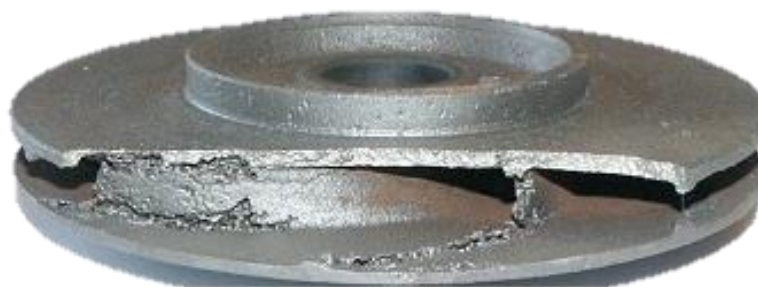
Rys.5. Wirnik pompy z widocznymi wżerami kawitacyjnymi
