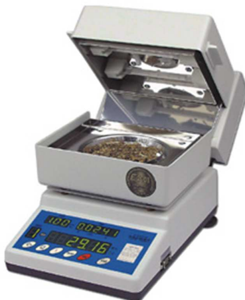
Rys. VI.4.1. Wago-suszarka stosowana do oznaczania wilgotności materiałów i mas formierskich [13]
