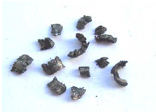
Rys.11. Kształt wióra przy obróbce stali w warunkach kruchości na zimno, badania własne.
