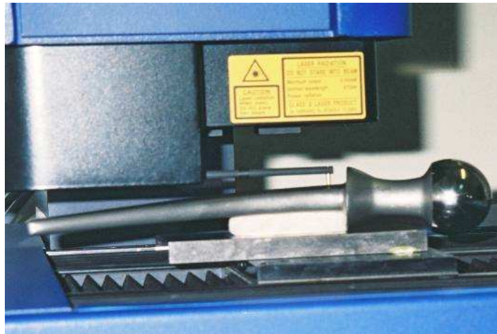
Rys. 2. Badania powierzchni trzpienia endoprotezy Wellera
