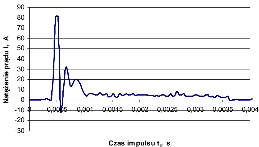
Rys. 4. Pojedynczy impuls wyładowania elektrycznego ( I = 3 \text{ A} ; C = 300 \mu\text{F} )
