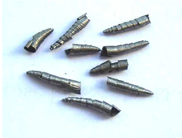
Rys.10. Wiór ciągły (śrubowy stożkowy), materiał obrabiany – żeliwo szare 200, v_c = 31,2 m/s, F = 0,1 mm/obr., \gamma = 0^0 , badania własne.
