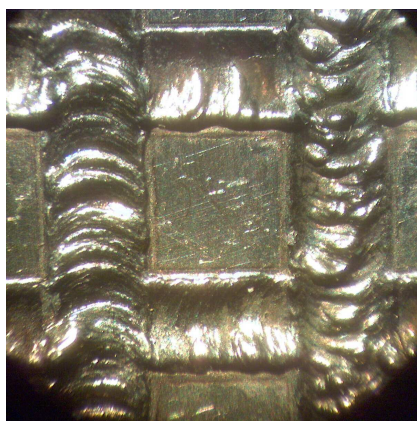
Вигляд поверхні сталі 20X13 після лазерного опромінення (x100)
