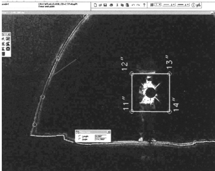
Rys. 5.8. Wektoryzacja przekroju podziemnego tunelu (wg. Trela, Stój, 2003]; widoczny jest czteropunktowy szablon i osoba trzymająca urządzenie w trakcie rejestracji.
