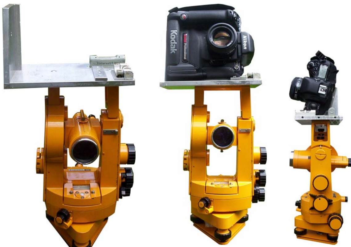
Nasadka zamocowana na teodolicie
