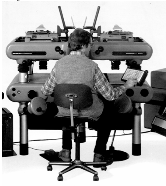
Rys. 3.10. Autograf Wilda Aviomap – widoczne są drążki rekonstruuujące parę promieni rzucających. Operator przemieszcza przestrzenny znaczek pomiarowy ruchami 2 pokręteł ręcznych ( X, Y ), oraz tarczy nożnej ( Z ).
