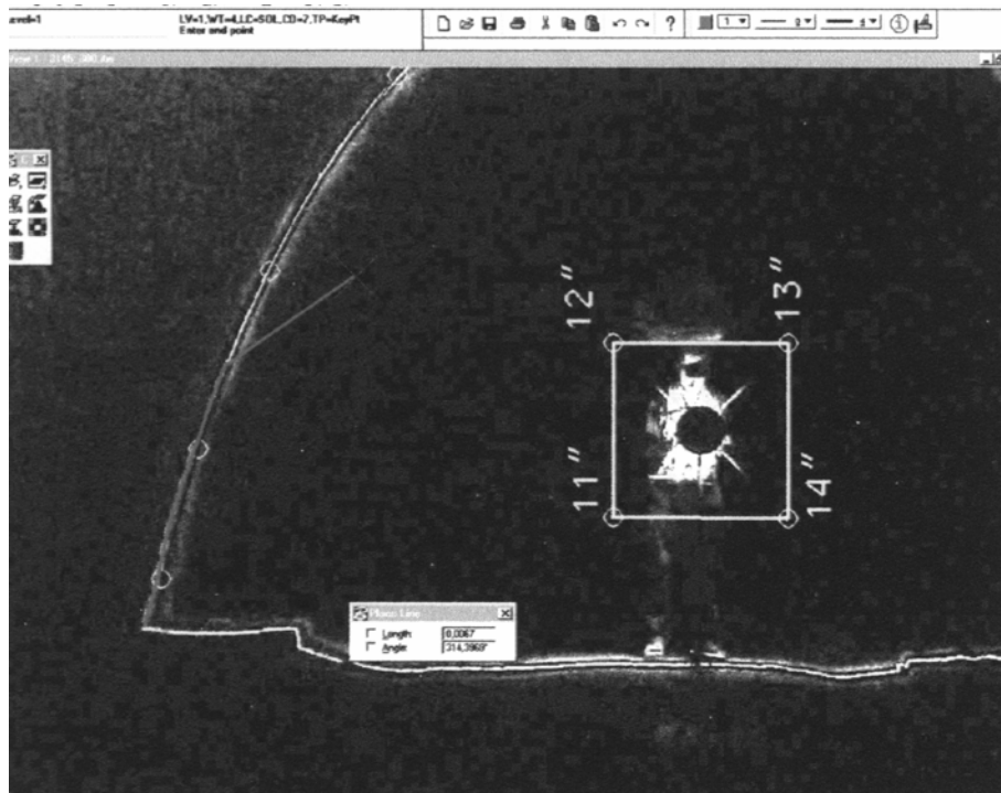
Rys. 9. Wektoryzacja przekroju podziemnego tunelu (wg. [Trela, Stój, 2003]); widoczny jest czteropunktowy szablon i osoba trzymająca urządzenie w trakcie rejestracji.
