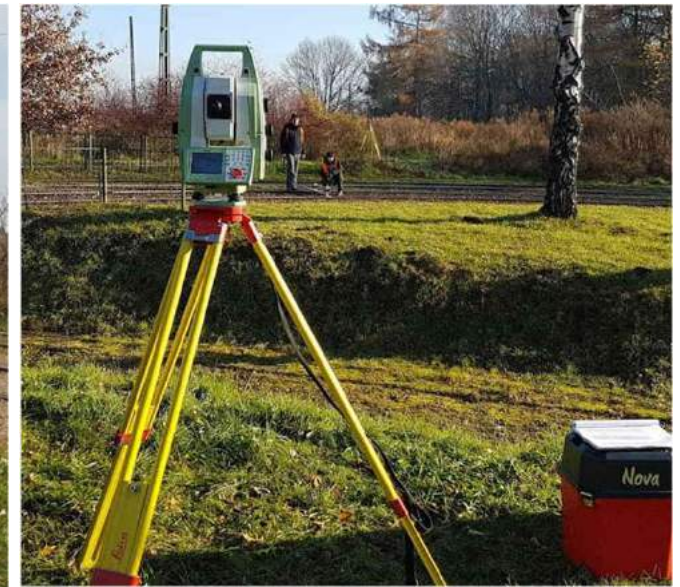
a - toromierz elektroniczny TEC-1435 N3 firmy Graw, b - belka firmy Trimble do pomiaru torów tramwajowych, c – twardościomierz przenośny MC-660A D firmy max:control, d - profilomierz PXY firmy Graw, e – niwelator kodowy DNA03, f – tachymetr Leica Nova MS50.
