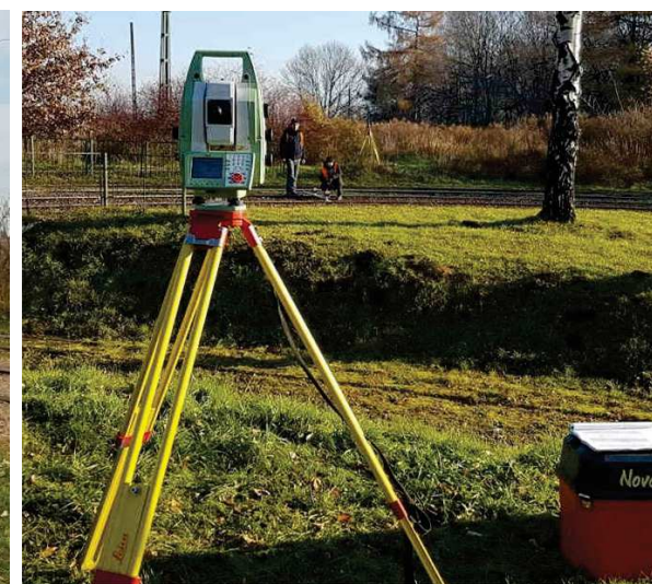
a - toromierz elektroniczny TEC-1435 N3 firmy Graw, b - belka firmy Trimble do pomiaru torów tramwajowych, c – twardościomierz przenośny MC-660A D firmy max:control, d - profilomierz PXY firmy Graw, e – niwelator kodowy DNA03, f – tachymetr Leica Nova MS50.
