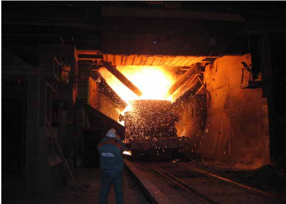
Dodawanie żelazostopów w czasie spustu metalu.
