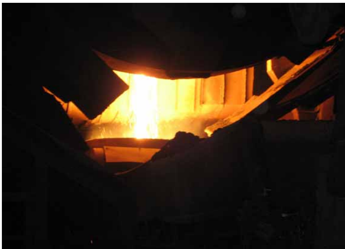
Spust metalu z konwertora do kadzi stalowniczej.
