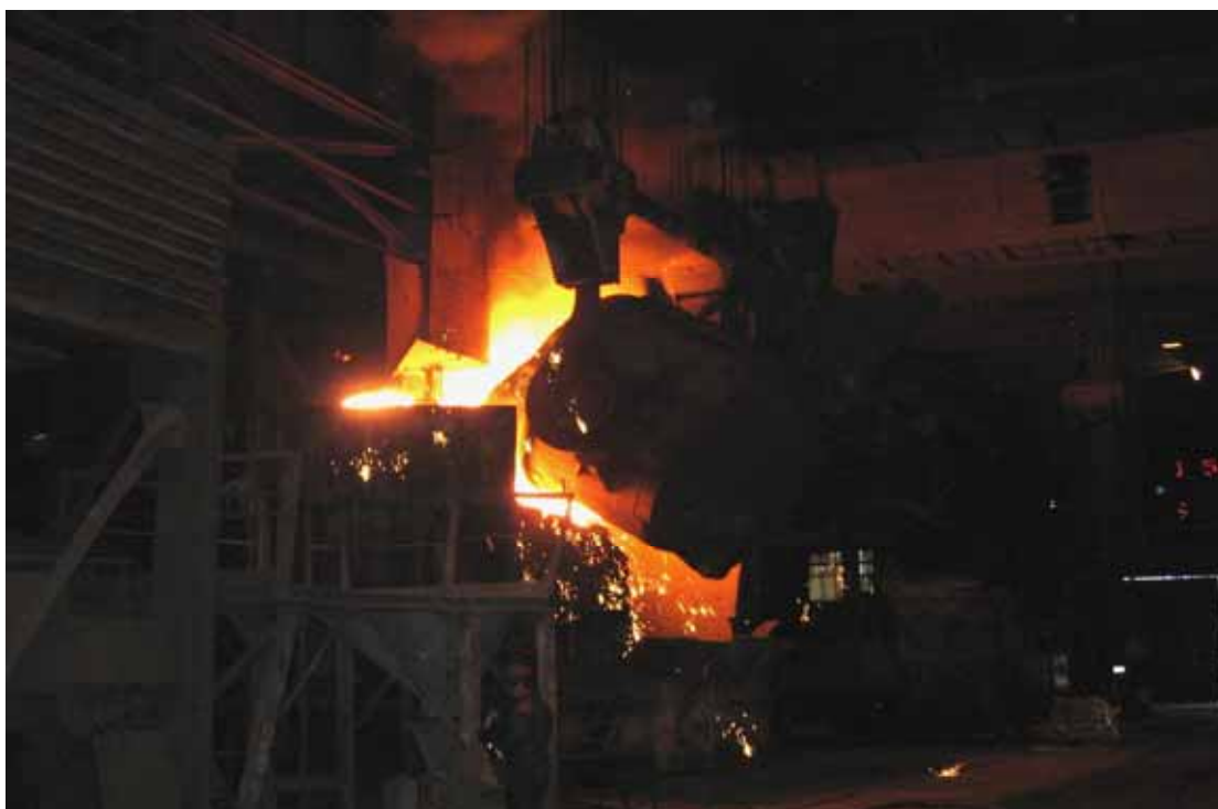
Zalewanie konwertora ciekłą surówką.
