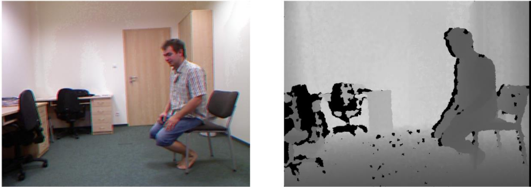
Rysunek 2.3. Obraz kolorowy i odpowiadający mu obraz głębi. Odległość na obrazie głębokości reprezentują odcienie szarości. Im większa jest jasność piksela tym odległość od kamery jest większa. Czarny kolor obrazuje piksele, dla których nie udało się określić głębokości (ang. non-measured depth, nmd ).
