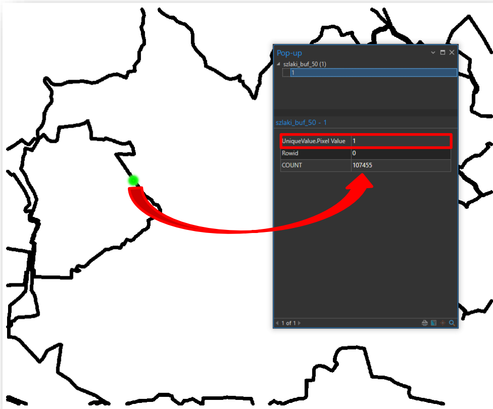
Ryc. 34. Warstwa rastrowa 50-metrowych buforów wokół szlaków turystycznych z zaznaczonym pikselem
