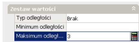
a) Ustalenie górnego zakresu parametru R na 3 ograniczą średnicę otworu do 6
