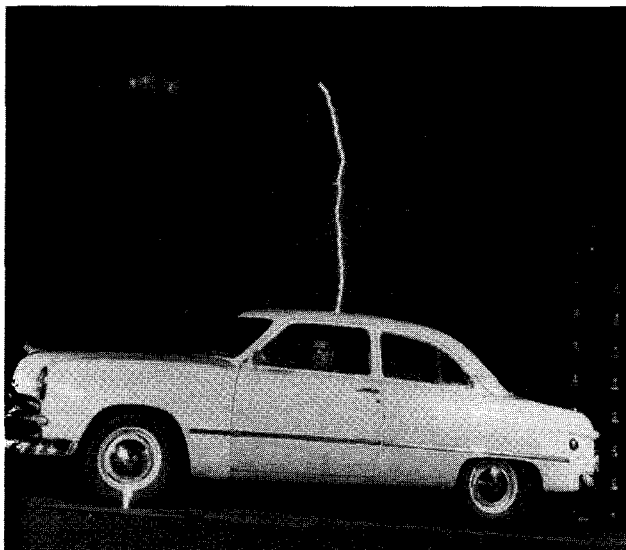
Rys. 25.19. Duża iskra uderza w karoserię samochodu i przechodzi do ziemi przez izolującą lewą przednią oponę (można tam dostrzec błysk). Osoba w samochodzie pozostaje nietknięta
