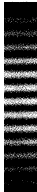
Rys. 36.7. Fotografia obrazu interferencyjnego wytwarzanego w układzie doświadczalnym pokazanym na rysunku 36.6 (widok z przodu części ekranu C ). Naprzemiennie występujące maksima i minima nazywane są prążkami interferencyjnymi (z powodu ich podobieństwa do prążków dekoracyjnych na odzieży czy dywanach)
