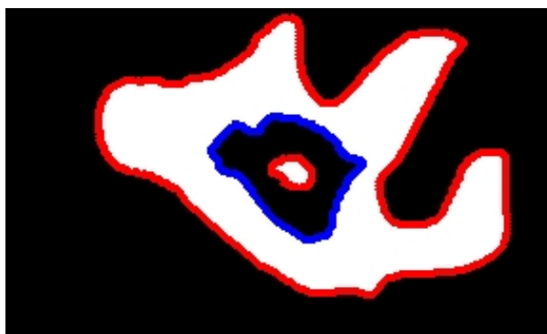
Rysunek 2: Efekt działania funkcji bwboundaries z parametrami 'noholes' - kolor czerwony, i 'holes' - czerwony + niebieski
