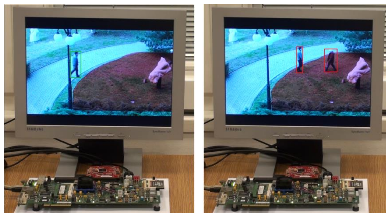
Rys. 2. Rekonfigurowalny system wizyjny do detekcji strefy zabronionej: a) osoba zbliża się do strefy zabronionej, b) dwie osoby znajdują się w strefie zabronionej
