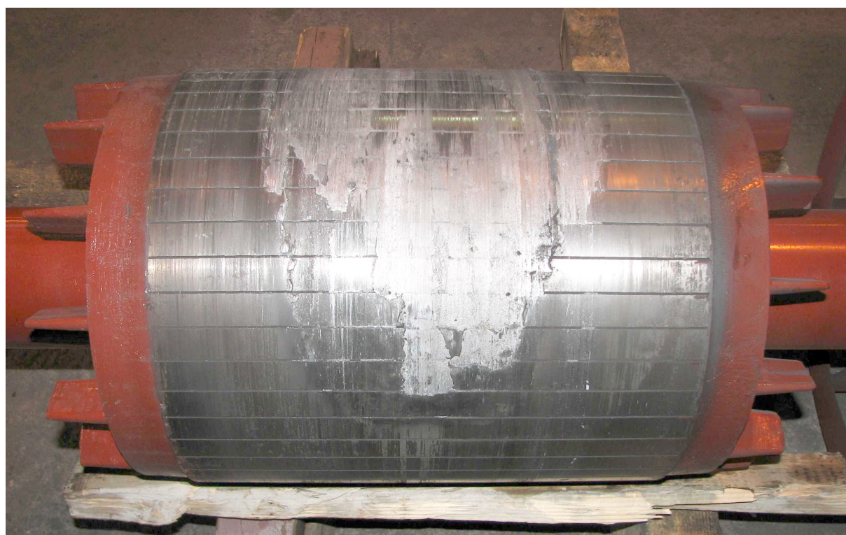
Rys 1. Wirnik uszkodzony w wyniku wytopienia prętów klatki
