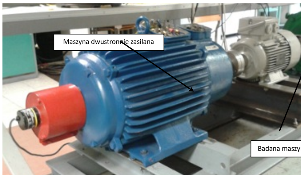
Rys. 13 Maszyny zainstalowane na stanowisku laboratoryjnym
